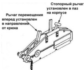
Рис. 11. Разблокирование устройства натяжения арт. AXS520
