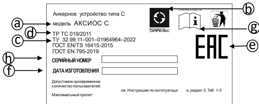
Рис. 1 Пример маркировки анкерной линии АКСИОС С
